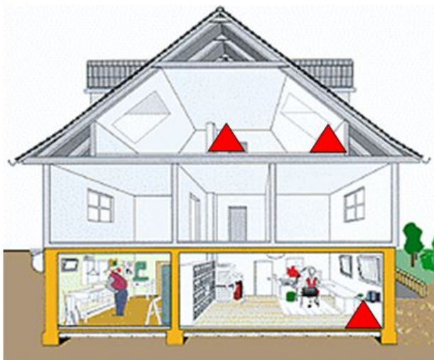
Abb. 120: Messpunkte im Gebäude, oberstes Vollgeschoss und Fundamentmesspunkt
