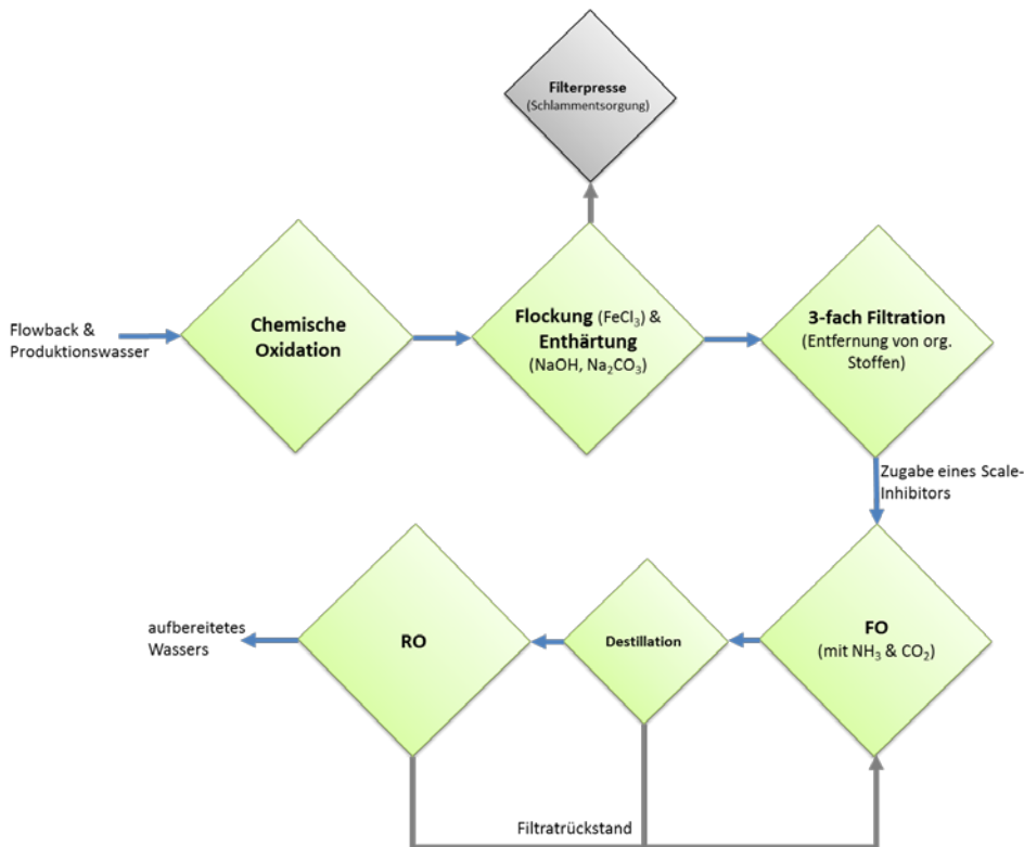
Abb. 51: Prozessschema der Pilotanlage zur Flowbackaufbereitung
